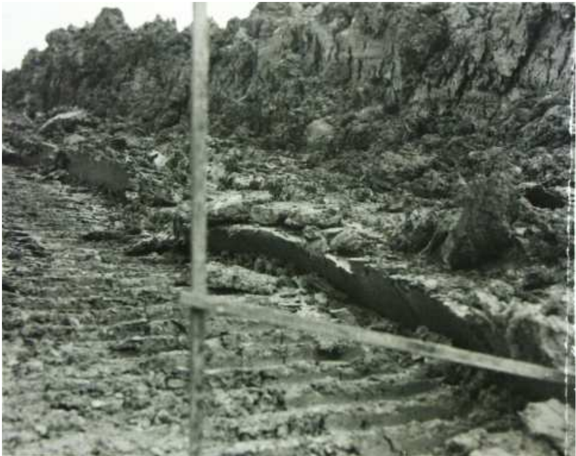
Provozní měření pohybu výsypky ve vytvářené deformační zóně. (Foto - archiv SU)
